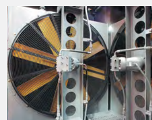
Вентилятор охлаждения гидравлического масла
